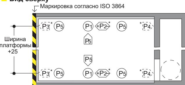
\* Нагрузка Р2 возникает только тогда, когда стойки закреплены к боковым стенам. Нагрузки Р3 и Р4 - когда стойки нельзя закрепить к боковым стенам.
