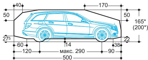
\*Общая высота автомобиля, включая рейлинги на крыше и крепления антенны, не должна превышать приведенных на схеме габаритов!
