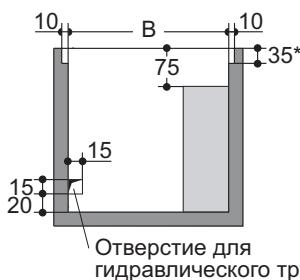
Отверстие для гидравлического трубопровода
