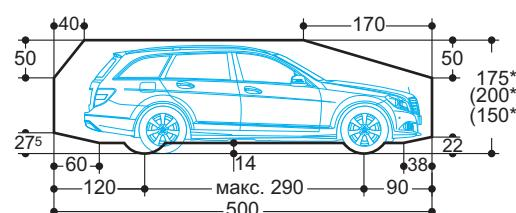
\* Общая высота автомобиля, включая рейлинги на крыше и крепления антенны, не должна превышать приведённых на схеме габаритов.
